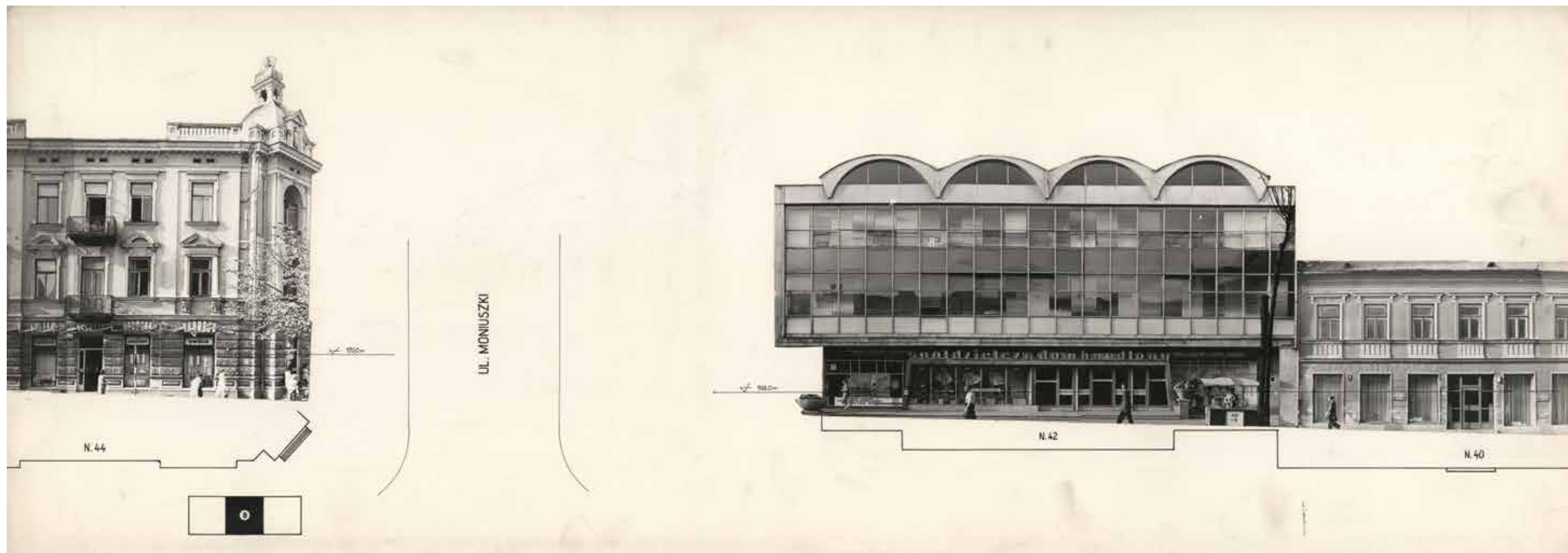
Sezam - Inwentaryzacja elewacji budynków metodą fotogrametryczną ul. Żeromskiego strona parzysta, 1971-1975 rok.
